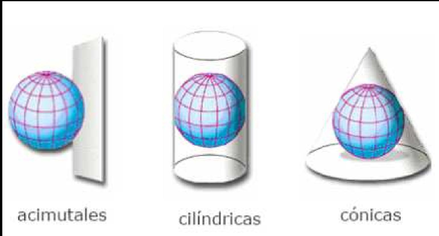
Figura 5: Proyecciones según figura geométrica.
